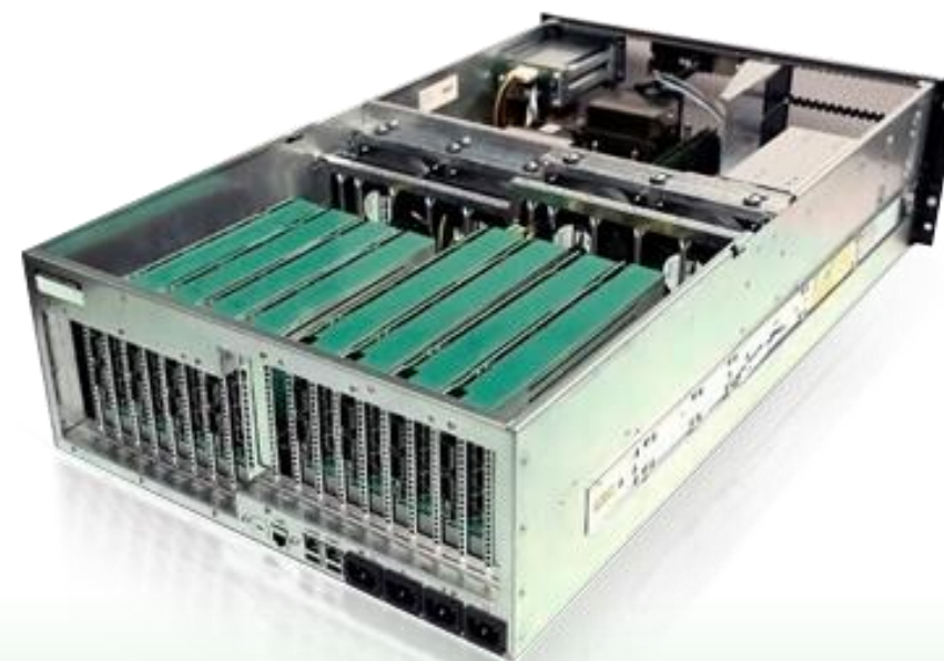
Шасси 3U, 8 модулей / 16 портов по 100 Гбит/с
